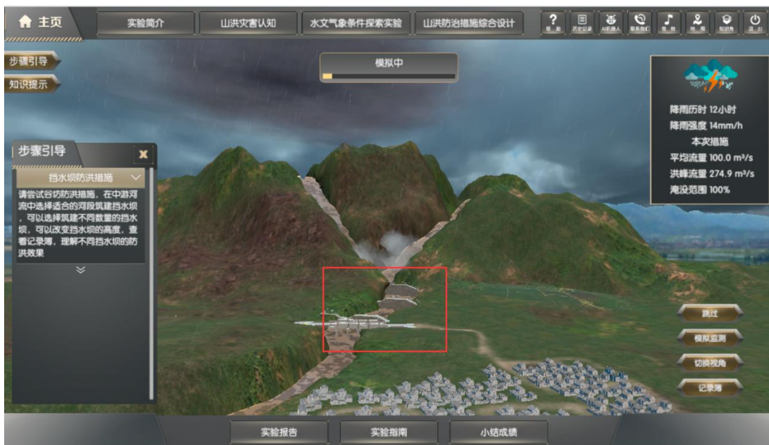
图 3-45 挡水坝防洪措施下的山洪动态过程
