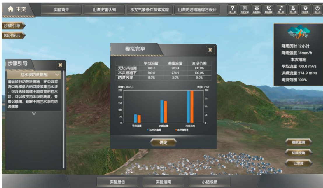
图 3-46 挡水坝措施下的防洪效果
